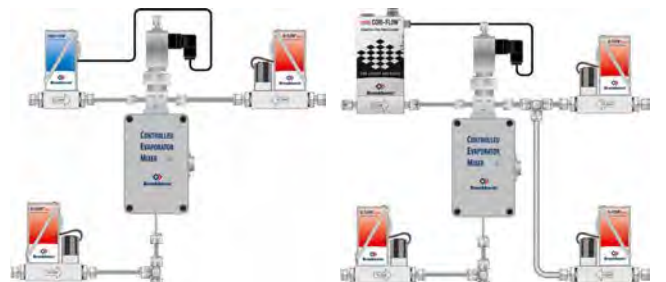
Tek taşıyıcı gaz, seyreltmeli, termal sıvı debi metresi
